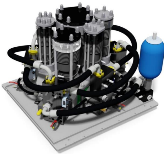
Kuva 9. Linden viisivaiheinen ioninestekompressorin IC90, maksimi kapasiteetti 370 Nm 3 /h ja loppupaine 1000 baaria, imupaine 5–200 baaria sekä teho 75kW. (Linde, 2019)
